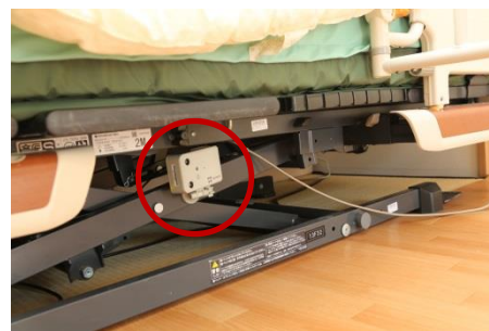
【超音波・赤外線センサー設置場所】
