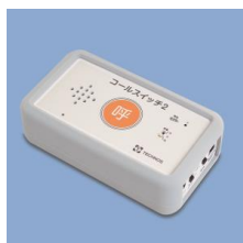
【コールスイッチ 2】 ボタンを押す以外に 声・音声で呼び出し可能
