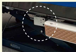
ベッド下に設置、ベッドから足を下ろし立ち上がる動きをキャッチ
