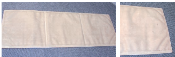
ガムテープを使用しセンサーカバーが縮んだ状態 (縮みが内部電極を圧迫し誤報の原因となります)
