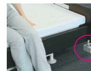
赤外線コールでベッドから降りようとするをお知らせ
